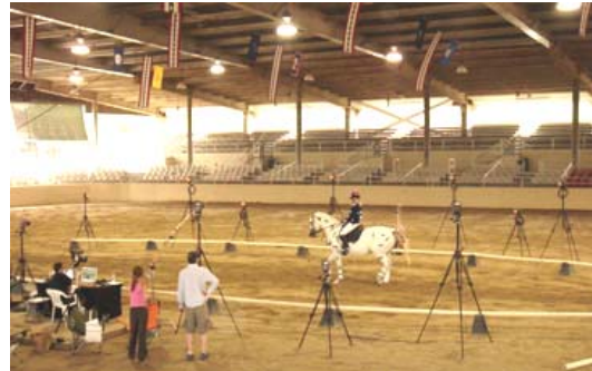
(그림 7) 광학식 모션캡처시스템을 이용한 말과 기수의 동작 분석
