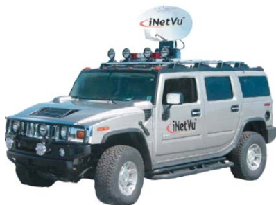
(그림 7) 차량 탑재용 전개형 반사판 안테나
