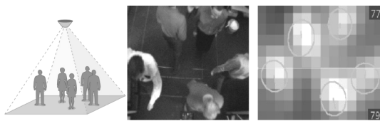
<자료>: Infrared Integrated Systems 사 (그림 8) 적외선 센서 어레이(16 \times 16)를 이용한 지능형 보안 시스템
