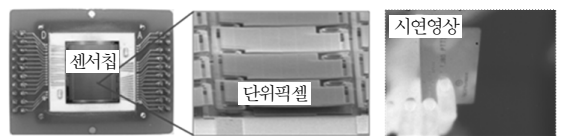
(그림 7) ETRI-i3system 공동으로 개발한 볼로미터형 QVGA급 적외선 영상 센서 시제품
