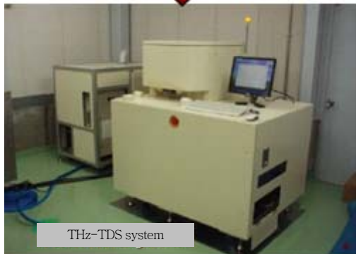
(그림 6) 일본 RIKEN의 2단계 우편물 검색장치. 1차 X-선 검사와 2차 테라헤르츠 검사를 거쳐 위험물을 검색
