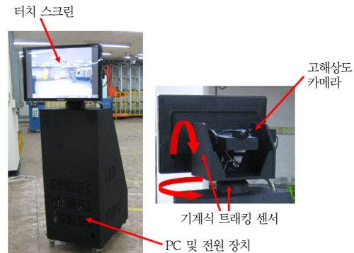
(그림 15) 혼합현실 기반 가상 공정 검증 플랫폼 하드웨어 구성
