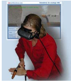
(그림 3) 가상현실 기반 용접 훈련 시뮬레이션 기술 (123 Certification Inc.)
