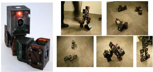
(그림 8) CKbot Module Cluster와 재구성 동작 모습[7]
