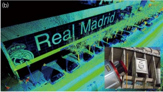
(그림 3) RIEGL의 Laser Scanner 형태(a) 및 수집된 영상 정보(b)
