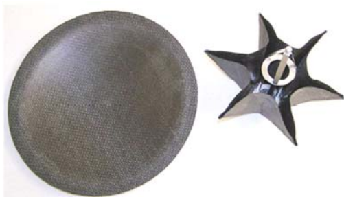
(그림 13) 형상기억고분자 반사경(직경 0.5m)[20]
