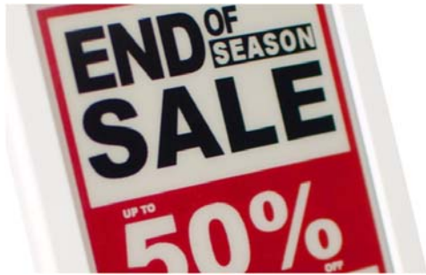
(그림 7) 세 종류의 입자를 이용한 E-Ink사의 Spectra 컬러 이미지 필름
