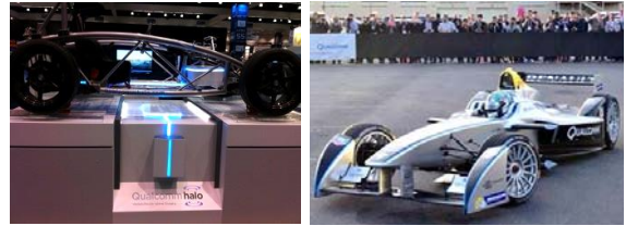
(그림 8) Qualcomm Halo의 자기유도 전기자동차 무선충전
