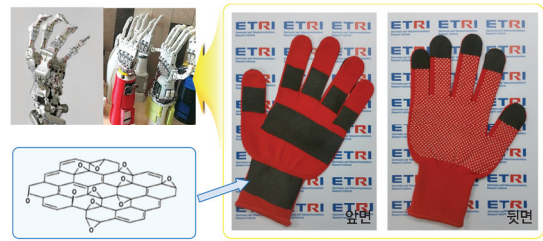
(그림 5) ETRI에서 개발 중인 그래핀 섬유 기반 모션센서
