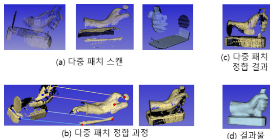
그림 2 3D 스캔 데이터 후처리 과정
