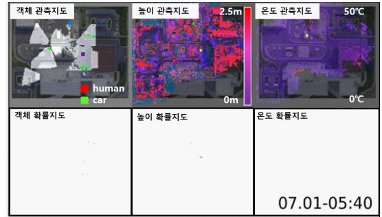
그림 7 사람/차량 등의 동적 객체, 높이변화, 온도변화에 대한 관측지도와 확률지도로 구성된 환경지도 예
